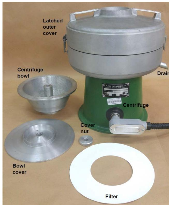
Figure 1. Centrifuge apparatus.
