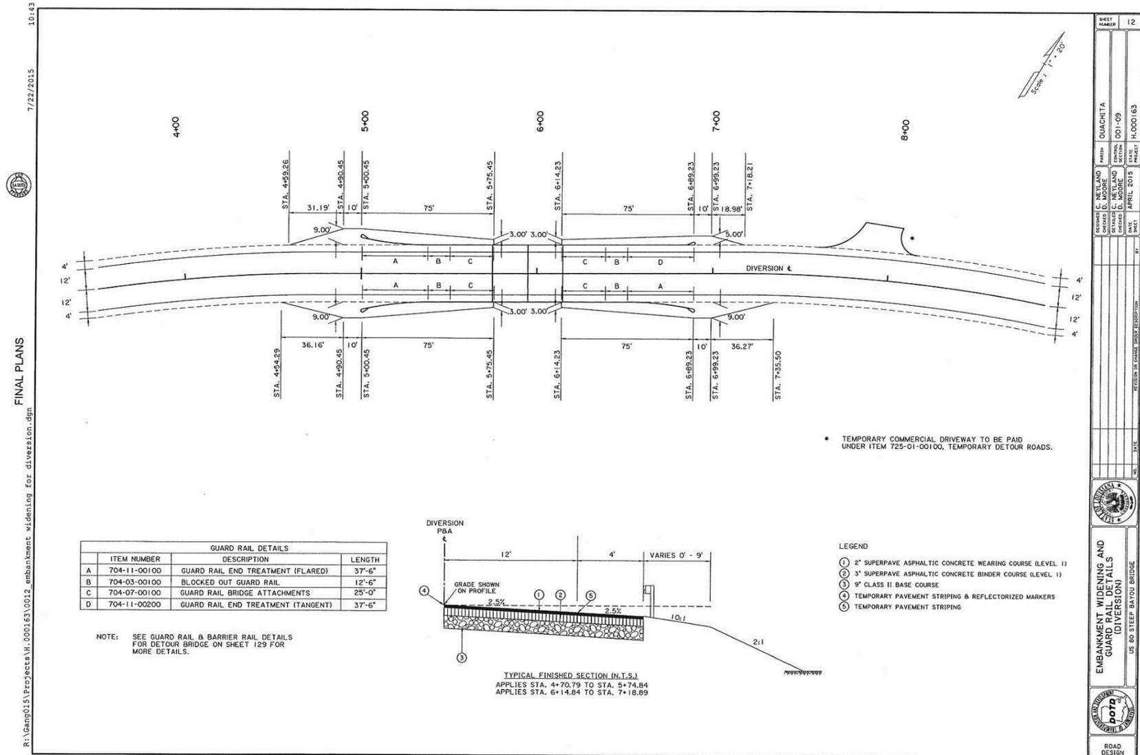
**EXAMPLE 2 – EXAMPLE EMBANKMENT WIDENING FOR GUARDRAIL LAYOUT**
